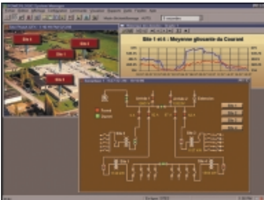
Ej.: Supervisión de una red eléctrica con SMS y Sepam series 20 y 40.
