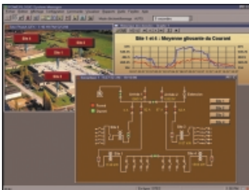
Supervisión de una red eléctrica equipada con Sepam gracias al software SMS de PowerLogic System.
