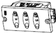
VPIS: Voltaje Presence Indicating System (Sistema de indicación de presencia de tensión)
