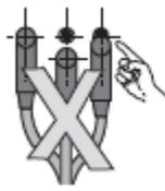
Los cables deben cortarse a la longitud adecuada para cada fase (en particular en caso de cables tripolares).
