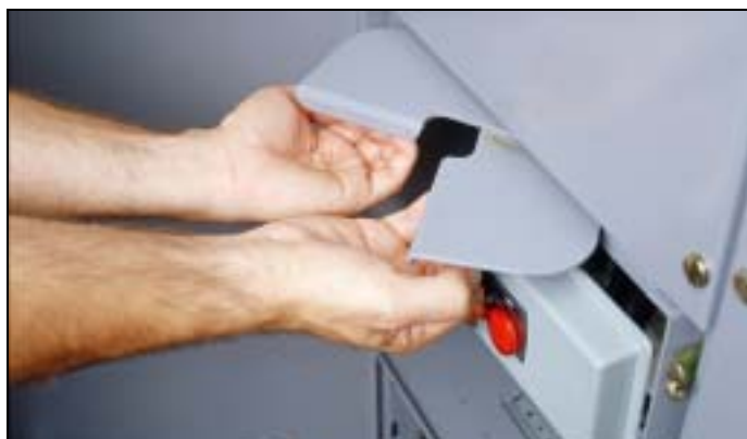
Figure 48 : Tirage vers soi des deux poignées du mécanisme à came
