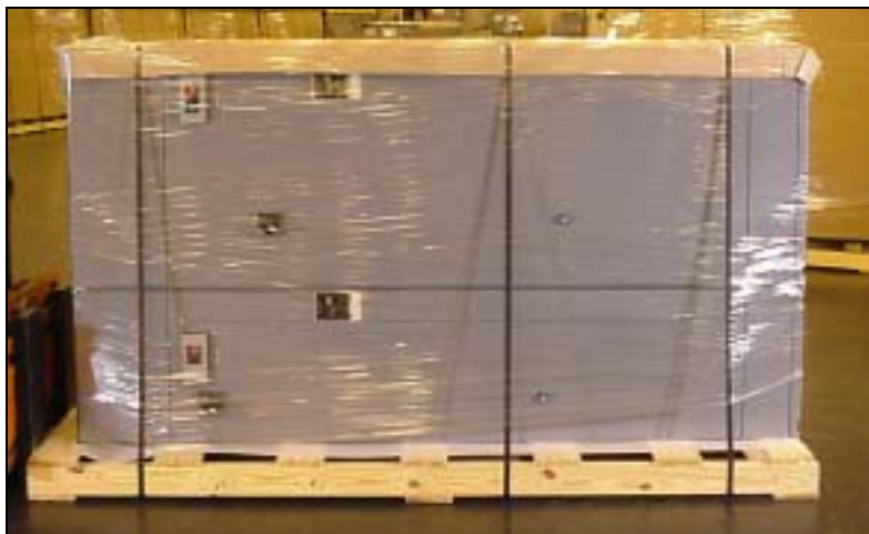
Figure 2 : Tableau de départs moteur débrochables Export emballé
