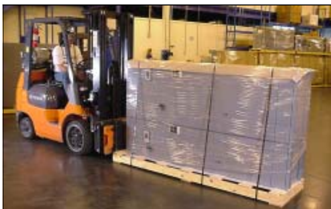
Figure 3 : Déplacement d'un tableau avec un chariot élévateur
