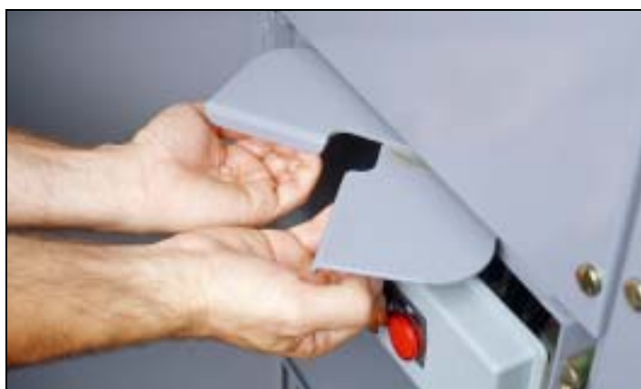
Figure 31 : Tirage vers soi du mécanisme à came à double poignée
