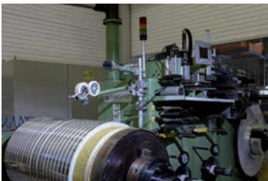
Bobinado de MT con tecnología de banda
