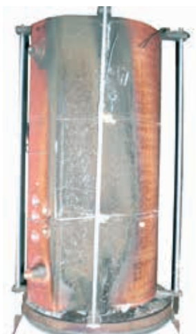
Ensayo de resistencia al fuego F1
