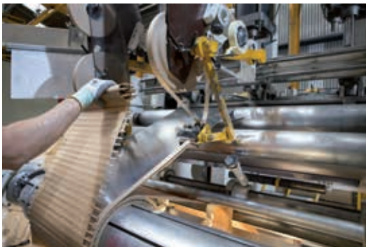
Bobinado de BT con tecnología en banda
