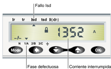
Visualización de la corriente interrumpida.
